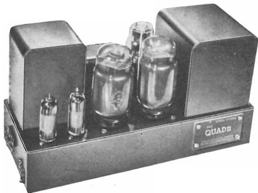
Fig. 5. - Aspetto esterno dell'amplificatore di potenza. In primo piano i due EF86 che pilotano la coppia di KT66. In secondo piano la raddrizzatrice GZ32.
