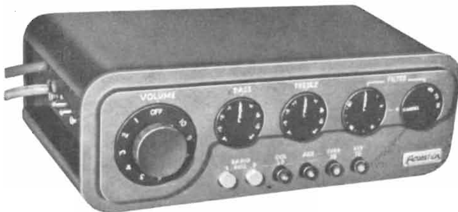
Fig. 2. - Aspetto esterno dell'unità di controllo che funziona da preamplificatore e da equalizzatore.
